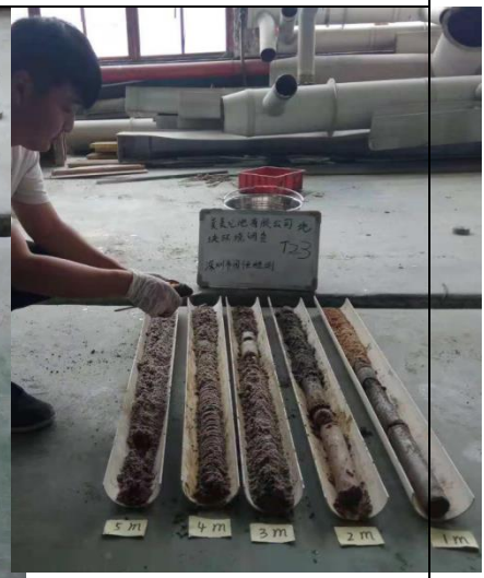
T23 土壤采样照片
